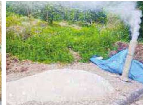
地面を掘ってしつらえた炭焼き窯
